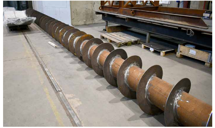
▲ Laserkeilaus on yksi Simetekin palveluista. Ensi kesänä yritys toimittaa Kuhmo Oy:lle ruuvikuljettimen, joka on valmistettu laserkeilauksen mittojen perusteella.
